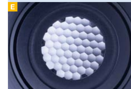
Lente fly-eye per un'illuminazione omogenea in fluorescenza
