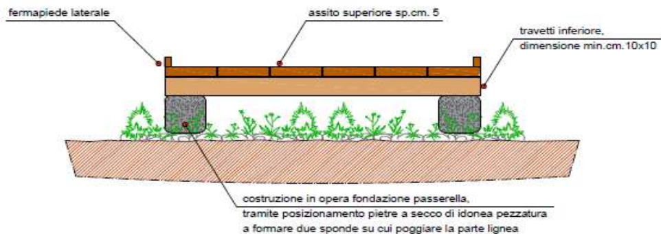
SCHEMA TIPO PONTICELLO - SEZIONE TRASVERSALE scala 1:10
